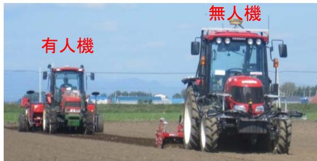
・写真は、衛星測位技術を用いて自動走行するトラクター
